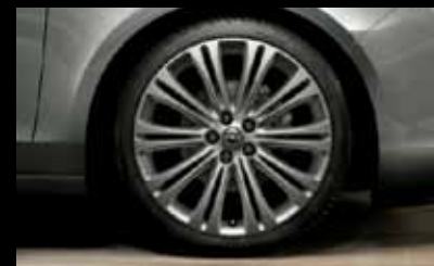
Легкосплавные колесные диски, 8 J x 19", многолучевой дизайн, темный титан, шины 235/40 R 19 (PZU).
